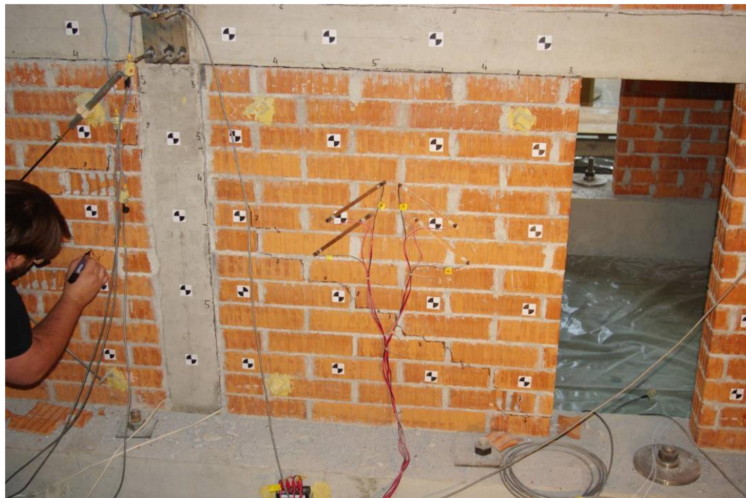
Pukotinske linije na ispunu modela 1
